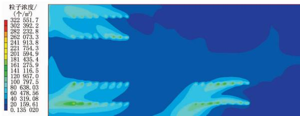
图6 H=0.5 m 水平面粒子浓度场示意图
