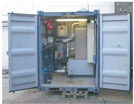
图 1 地热反应测试装置
