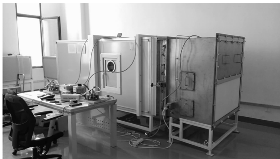
图3 根据标准建造的FFU通用试验台
