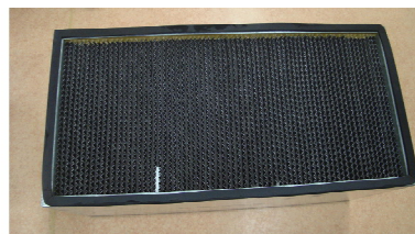
图 4 正在使用的高效过滤器进风面污染严重
