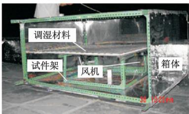
图 3 材料和风机的安置
