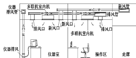
图 5 仪器室、操作区通风系统剖面图
