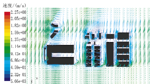
图14 距地面1.5m处室外风速矢量图
